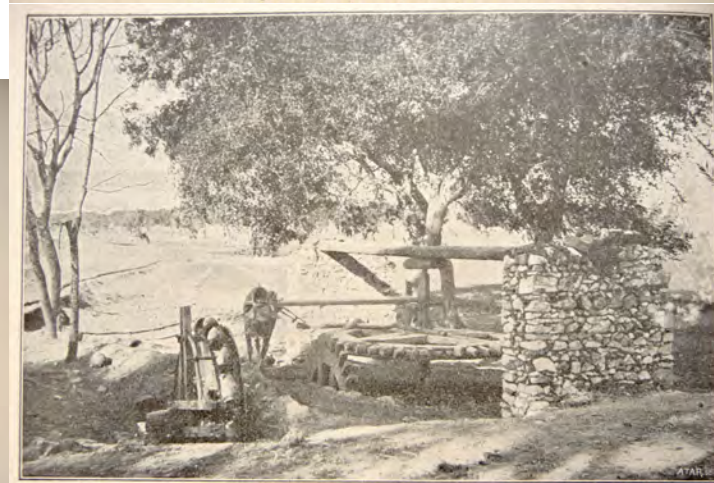
Fig. 40. — Une saqiya mise en mouvement par un buffle, dans les environs du Caire. Cliché de l'auteur, janvier 1899.
